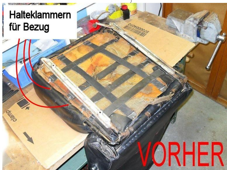
Die Halteklammern kann man leicht mit einem Schraubendreher abhebeln, verklebt ist der Bezug nicht.
