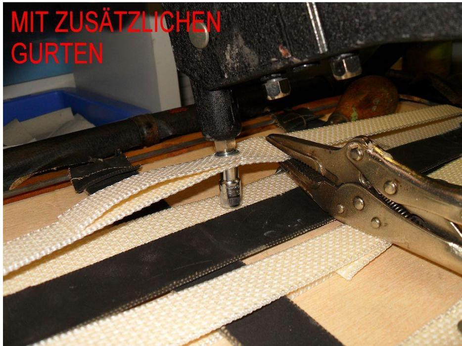
Die Rollladengurte wurden – wie die Gummibänder – um den Zwischenrahmen (umlaufender ca. 4 mm Draht) gelegt, gespannt und mit der Gripzange fixiert und anschließend mit je 2 Blindnieten mit untergelegten Karosseriescheiben endgültig verbunden.
